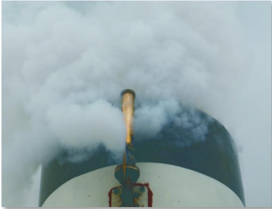
Stoomfluit op een schoorsteen van een stoomboot (je ziet de witte stoom wegblazen)
