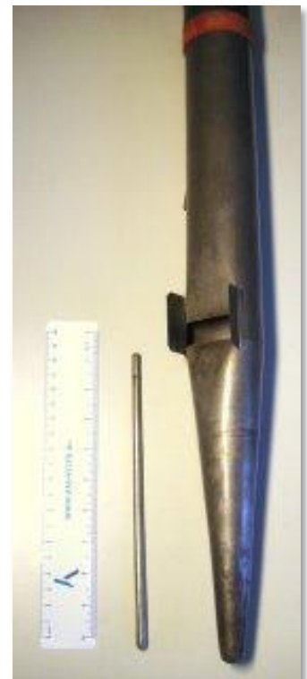
Hier zie je een heel klein orgelpijpje (kijk naar het maatlatje er naast) en een wat grotere orgelpijp. Welke zou de laagste toon geven?
